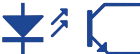
Schéma zapojení reflexního infračerveného senzoru
